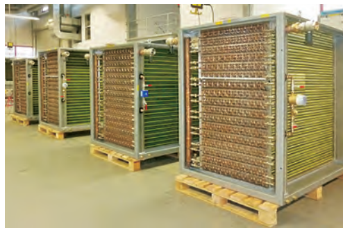
GSWT ® -Module in handliche Rohrrahmengestelle vormontiert
