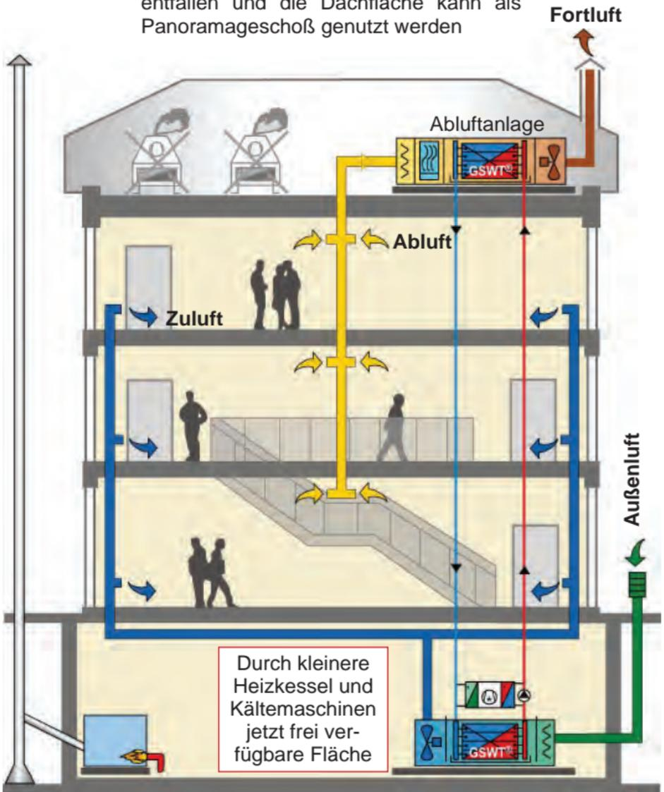
Gebäude mit hocheffizienter SEW®-Wärme- / Kälterückgewinnungstechnik mit absolut getrennten Luftströmen
